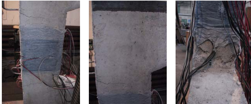
Фиг. III.107 – Начин на разрушение на усилените елементи от серия „B”
